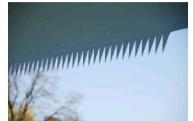
Photo 61 : Photographies d'une pale dotée d'un système STE (peigne / dentelure) (Source : VENATHEC)
