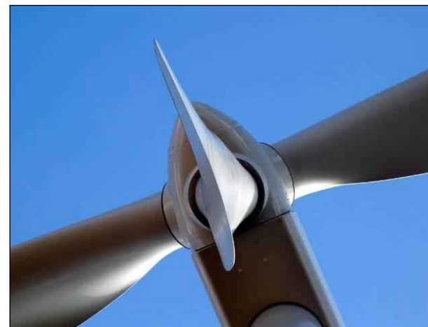
Photo 60 : Annulation de la portance des pales d'éolienne par "mise en drapeau" (Source : Larousse.fr)
