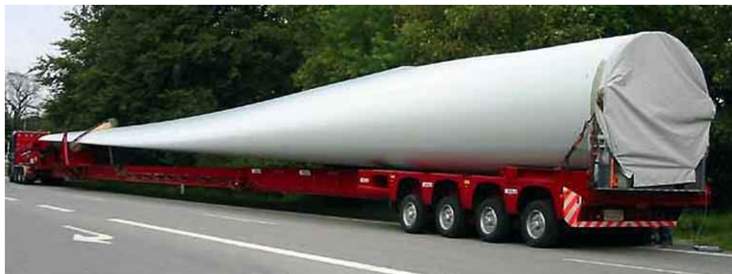
Photo 50 : Exemple de transport de pale par convoi exceptionnel (Source : NICOLAS Industries)
