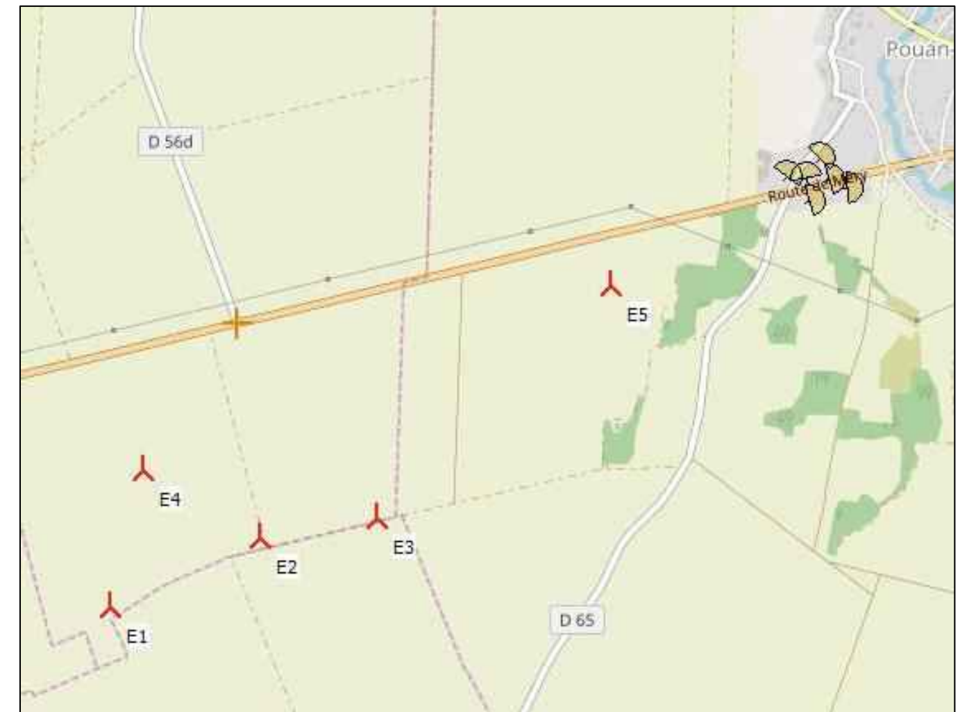
Carte 108 : Carte de localisation des éoliennes (en rouge) et des récepteurs (en jaune) utilisés pour le calcul des ombres portées (Source : RESONANCE)
