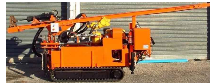
Photo 54 : Sondeuse de type wagon drill hydraulique (Source : FONDASOL)
